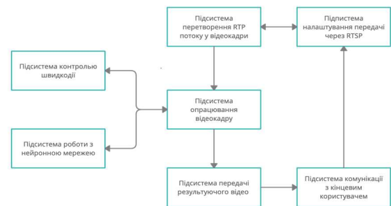
Рис. 8 Функціональна схема опрацьовання відеопотоку з використанням нейронної мережі
