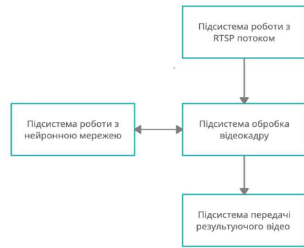
Рис. 7 Структурна схема опрацьовання відеопотоку з використанням нейронної мережі
