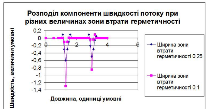
Рис. 9. Розподіл компоненти швидкості потоку при різних величинах зони втрати герметичності
