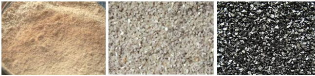
Рис. 1. Види засипок: алюмосилікат (а), кварцовий пісок (б), сульфовугілля (с)
